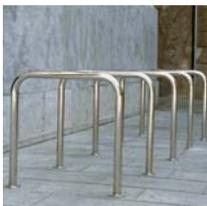
Se colocarán “aparca bicis” metálicos de acero inoxidable formado por perfiles tubulares de dicho material modelo Bici-N de Escofet o Equivalente para 7 plazas de bicis l=1.50 m y h= 0.73 m. anclados al pavimento con hormigón masa HM-20.
