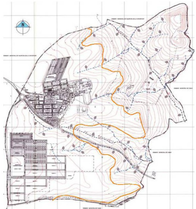
Plano topográfico con línea de estabilidad geomorfológica
